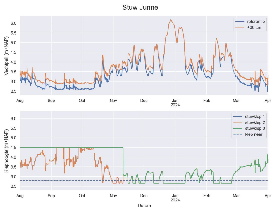
Figuur 2-5: Voorbeeld simulatie peilverhoging van 30 cm bij stuw Junne. De bovenste figuur toont het Vechtpeil conform metingen (referentie) en gesimuleerd met een peilverhoging van 30 cm. De onderste figuur toont de klepstanden voor de drie stuwkleppen. De stippellijn geeft de hoogte aan waarbij is aangenomen dat de stuwklep volledig gestreken is.
