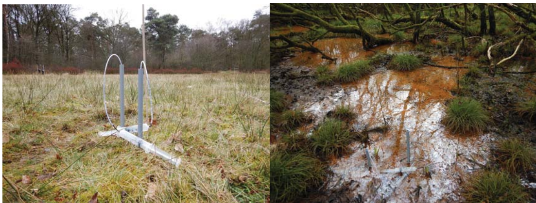
Figuur 2. Foto's van de locaties 261 (links) en 269 (rechts) waar met behulp van keramische cups (lysimeters) poriewater werd verzameld op 20 en 75 cm-mv. Foto's: Mark van Mullekom.
